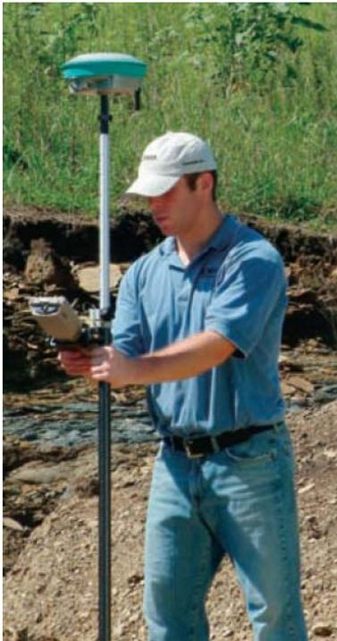
O GSR2700 IS da **SOKKIA** é um receptor integrado, dupla frequência. Este receptor pode executar trabalhos pós-processados e RTK (Tempo Real). O sistema integrado, receptor, antena, memória, baterias e link de radio interno para levantamento RTK, com tecnologia wireless - bluetooth.
